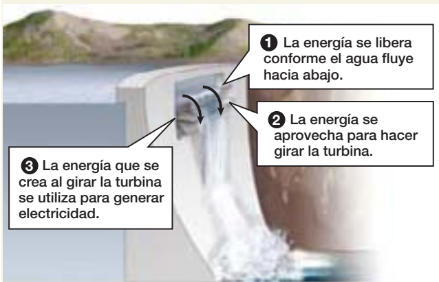
FIGURA E7-1 La energía almacenada en un "gradiente" de agua puede emplearse para generar electricidad
